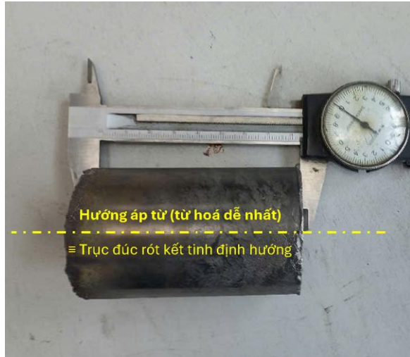
Hình 3. Ảnh mẫu phôi hợp kim Alnico AlNiCuCo35Ti5Nb thu được bằng công nghệ đúc kết tinh định hướng.
